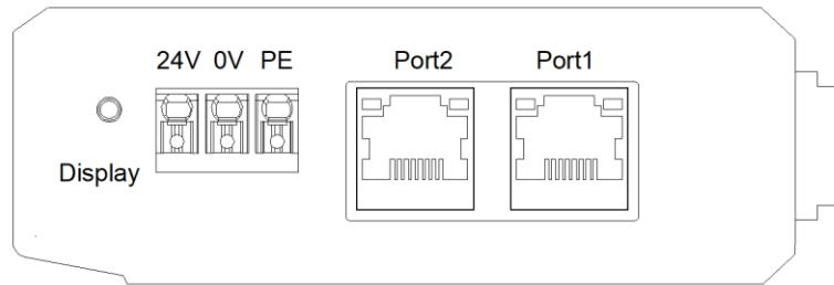
1、系统电源模块接线采用3Pin 3.5mm间距弹簧接线端子，端子定义如下：
