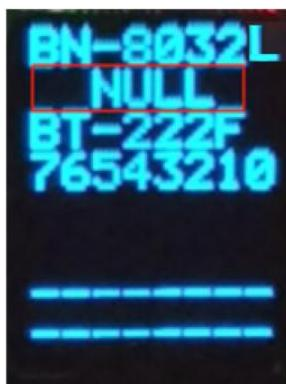
按液晶显示按钮切换到通讯板液晶界面，可显示模块型号、设备名称、软件版本、模块故障。
