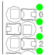
当通道的输入信号有效时，对应的通道指示灯与通道状态指示灯被点亮。
